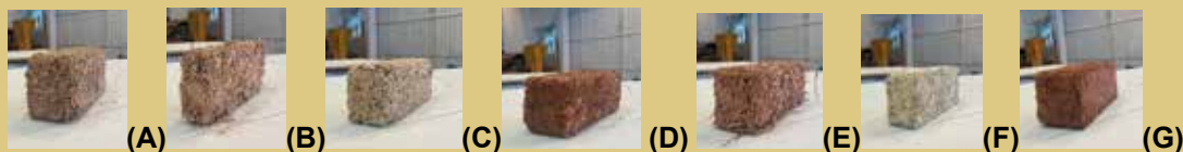
Figura 1: (A) Tijolo prensado com fibra curta não peneirada e nata de cal; (B) Tijolo prensado com fibra longa picada e nata de terra e cal; (C) Tijolo prensado com fibra curta peneirada e nata de cal; (D) Tijolo prensado com fibra curta não peneirada e nata de terra proporção 1:1; (E) Tijolo prensado com fibra longa picada e nata de terra; (F) Tijolo prensado com fibra longa picada e nata de cal; (G) Tijolo prensado com fibra curta não peneirada e nata de terra proporção 2:1. Fonte: elaborado pelos autores.
